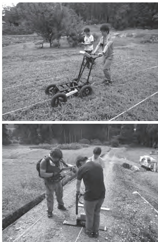
図1. 探査実施状況(上:500MHz, 下:100MHz)
